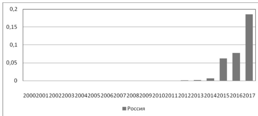
Рис. 4 Изменение мощности (ГВт), генерируемой фотовольтаическими электростанциями в России
