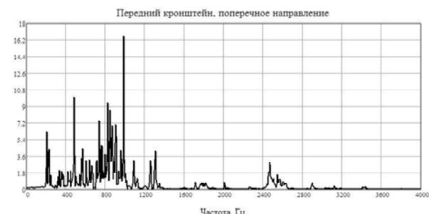
Рисунк 8. АЧХ поперечного ускорения переднего кронштейна.
