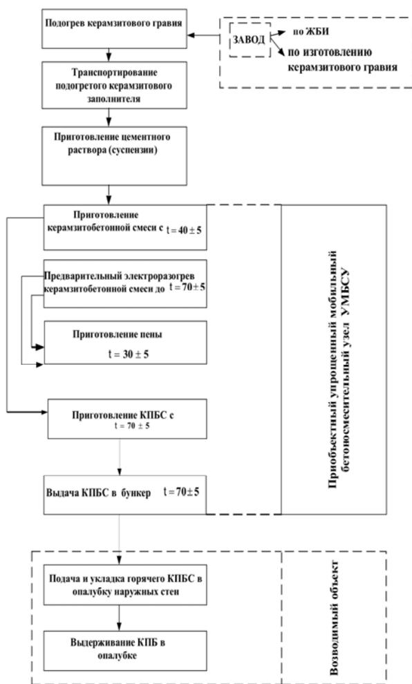
Рис. 2. Последовательность технологических операций по разделному приготовлению, разогреву бетонных смесей, их укладке и выдерживанию бетона.
