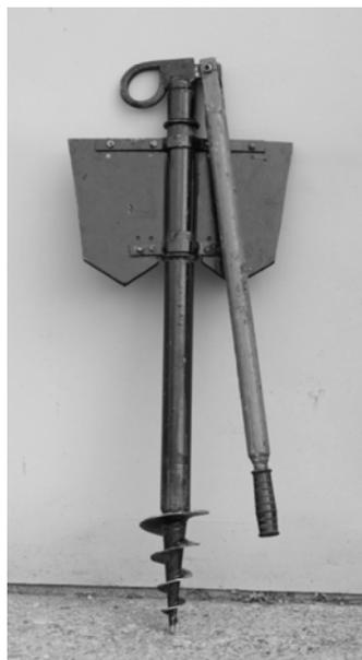
Рис. 3 Бур для самовытаскивания с помощью лебедки застрявшего транспортного средства
