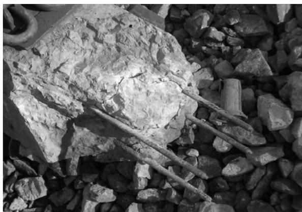
Рисунок 4. Четвёртая стадия разрушения шпал
