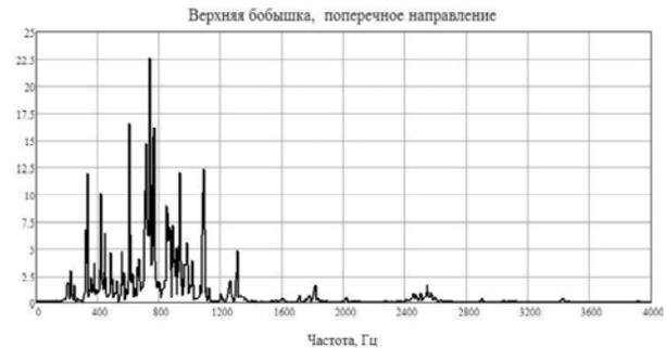
Рисунок 6. АЧХ поперечного ускорения верхней бобышки.
