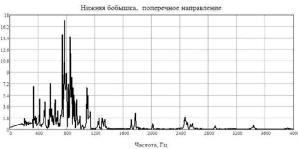
Рисунок 4. АЧХ поперечного ускорения нижней бобышки.
